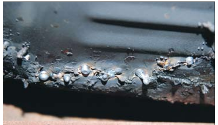
Svetsning utförd av Wasabil, golvsplåt vänster fram.
