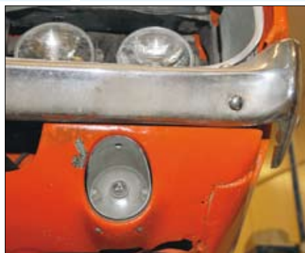
Spalt mellan kofångare och front mäter runt fem centimeter på vänster sida, cirka fem millimeter på höger. Fronten i övrigt har tydliga rosthål samt är grovt spacklad.
